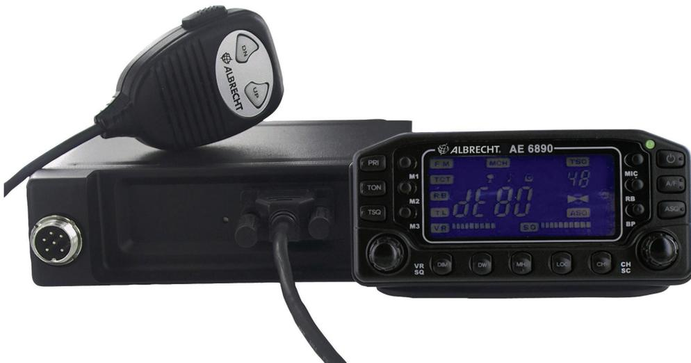
Benutzen Sie zum abgesetzten Anschluss das mitgelieferte ca. 2 m lange 9 polige Sub D Kabel.
