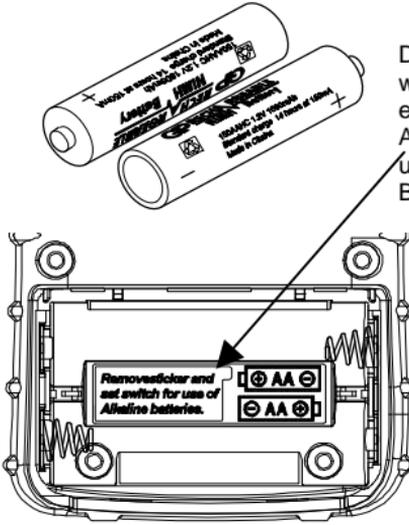
Der Batterie-Umschalter ist werkseitig auf NiMH Akkus eingestellt und mit einem Aufkleber verdeckt. (Entfernen, und umschalten, wenn andere Batterien benutzt werden sollen!
