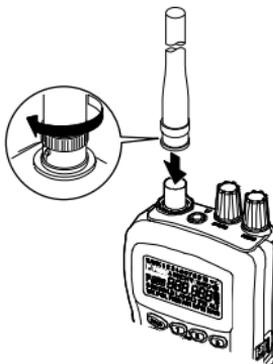
Die Antenne, egal ob die mitgelieferte Gummiantenne oder eine externe Antenne verwendet werden soll, wird über einen BNC Stecker angeschlossen. Diese Steckerform hat einen Bajonettverschluss, bei dem die beiden Schlitze im Stecker genau über die Führungsstifte der Antennenbuchse am Funkgerät geschoben werden. Eine kurze Drehung im Uhrzeigersinn lässt dann den Stecker fest auf der Buchse einrasten
