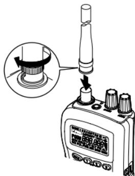
Die Antenne, egal ob die mitgelieferte Gummiantenne oder eine externe Antenne verwendet werden soll, wird über einen BNC Stecker angeschlossen. Diese Steckerform hat einen Bajonettverschluss, bei dem die beiden Schlitze im Stecker genau über die Führungsstifte der Antennenbuchse am Funkgerät geschoben werden. Eine kurze Drehung im Uhrzeigersinn lässt dann den Stecker fest auf der Buchse einrasten
