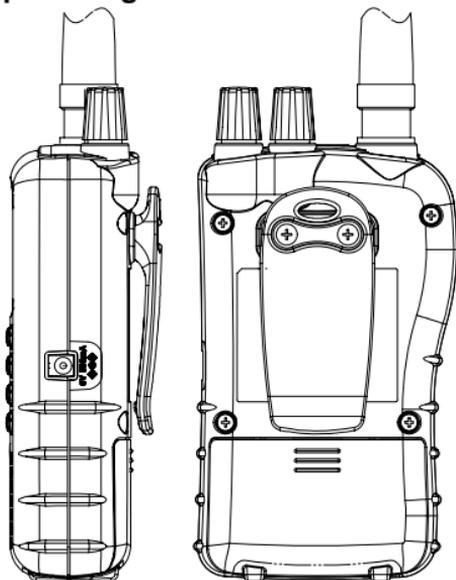
Benutzen Sie einen Kreuzschlitz-Schraubendreher zum evtl. Anbringen des Gürtelclips.
