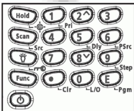
Ihr Scanner hat teilweise Doppelfunktionstasten. Die Erstfunktion ist auf der Taste aufgedruckt, die Zweitfunktion jeweils rechts daneben oder unter den Tasten.
