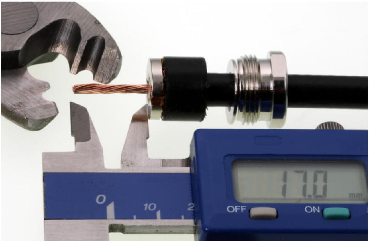
Mithilfe unserer Koaxkabelschere [KKS 16](#) wird der Innenleiter immer so geschnitten, dass die Innenleiterstruktur erhalten bleibt und der Mittelkontakt problemlos aufgesteckt werden kann.
