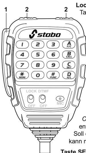
**Lock-Schalter** Tastatursperre: In Stellung *Lock* ist - bis auf die PTT-Taste - die gesamte Mikrofontastatur gesperrt, die Beleuchtung ist abgeschaltet.
